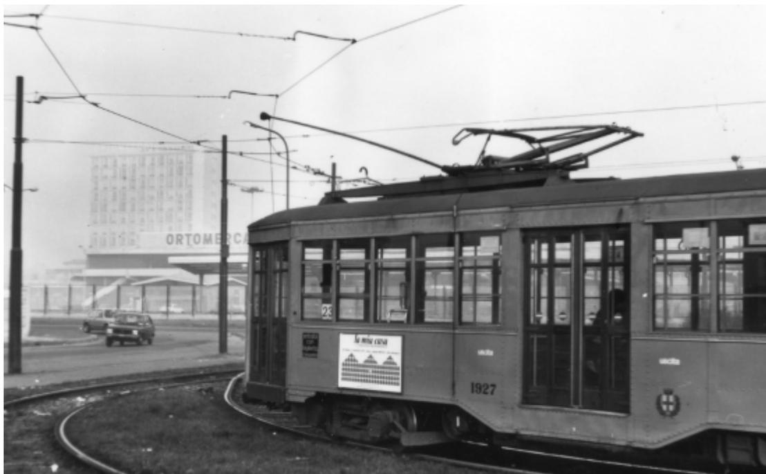
Figura D3.3: uno degli ultimi interventi del ritiratrolley AT-8 nel settembre 1978 al capolinea di via Monte Velino: durante la trasformazione della linea, un assetto evidentemente non ottimale dello scambio aereo causava regolari scarrucolamenti, tenendo conto che allora le vetture della linea 23 transitavano di regola sull'anello interno e quindi sul ramo deviato dello scambio.
