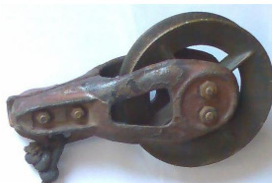
Figura D1.9: rotella piccola per vetture urbane in generale e rotella grande per vetture 4600/4700 e interurbane
